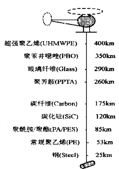
图 1 部分纤维的自由断裂长度
